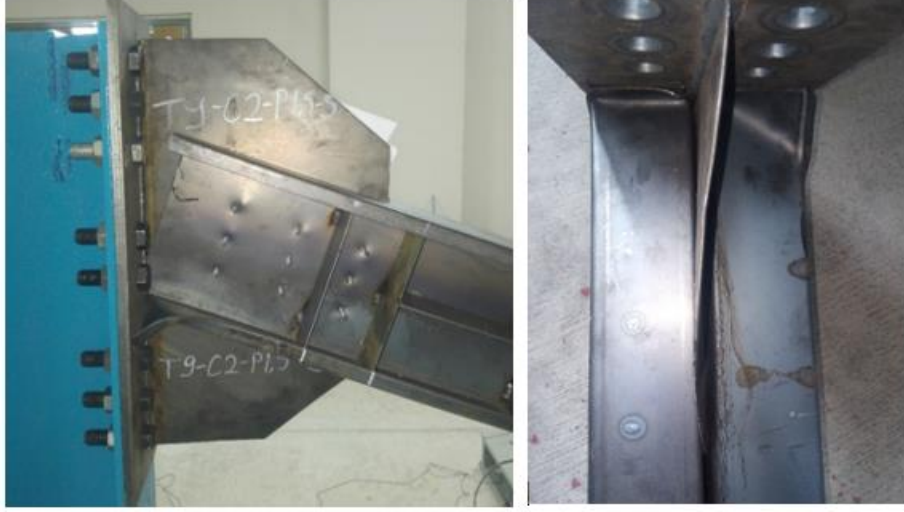
Şekil 16. T9-C2-P1,5-S Numunesinin göçme şekilleri
