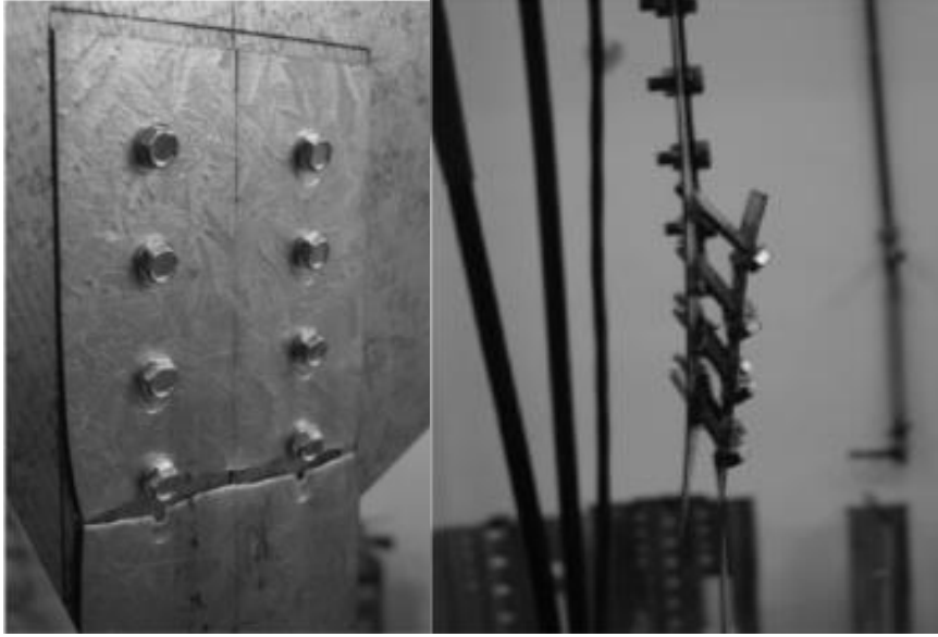
Şekil 1. Kesme deneyi sonrası vidalı birleşimde levhanın yırtılması
