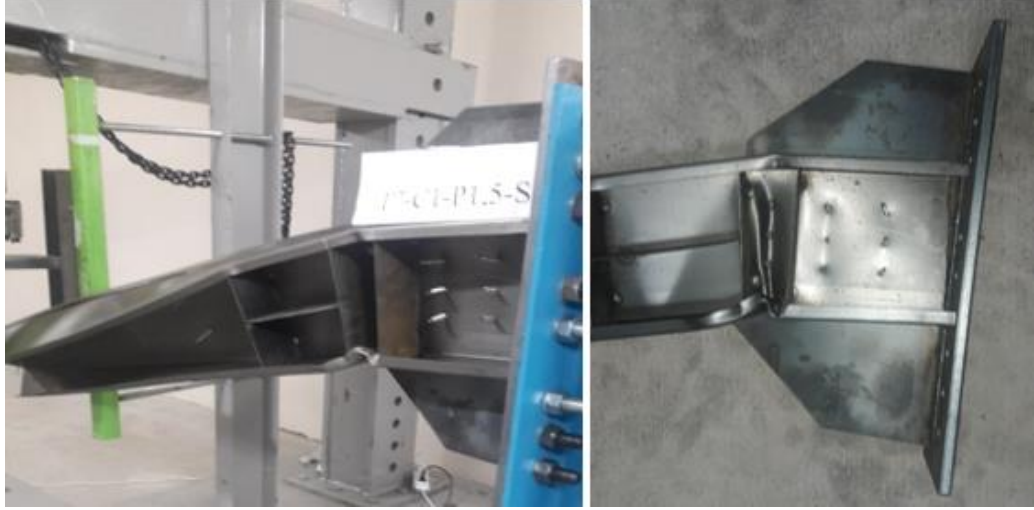
Şekil 12. T7-C1-P1,5-S Numunesine göçme şekilleri
