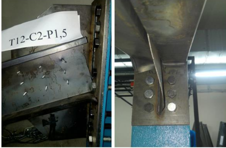
Şekil 20. T12-C2-P1,5 Numunesinin göçme şekilleri
