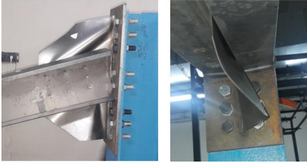
Şekil 8. T5-C1,5-P1 Numunesine göçme şekilleri
