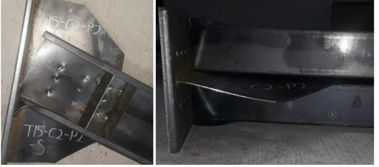
Şekil 26. T15-C2-P2-S Numunesine göçme şekilleri
