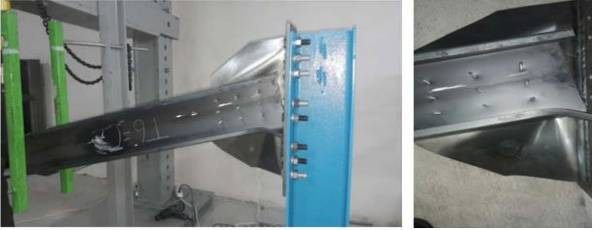
Şekil 10. T6-C2-P1 Numunesine göçme şekilleri
