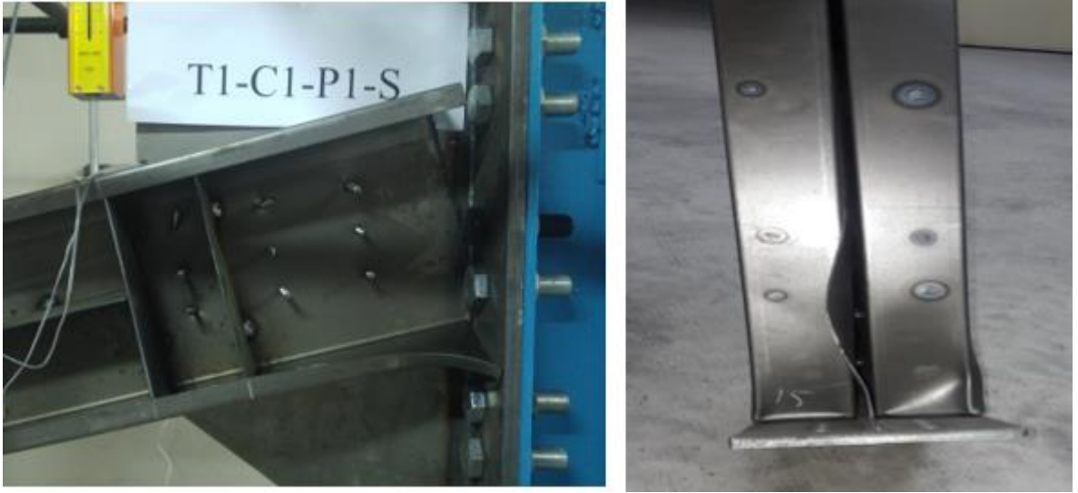
Şekil 7. T1-C1-P1-S Numunesine ait göçme şekilleri
