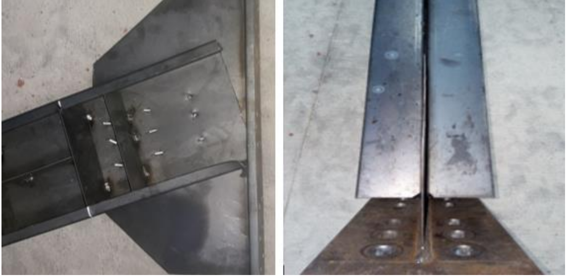
Şekil 24. T14-C1,5-P2-S Numunesine göçme şekilleri
