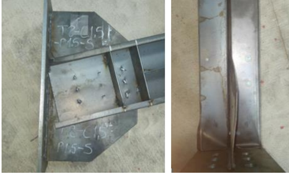
Şekil 14. T8-C1,5-P1,5-S Numunesinin göçme şekilleri
