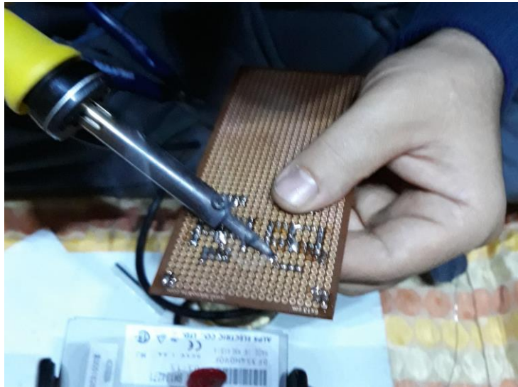
Şekil 5. L293D sürücülerinin devre kartına lehimlenmesi
