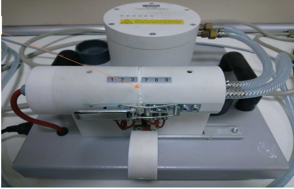
Şekil 3. Numunelerin deney düzeneğinde yerleştirilmesi
